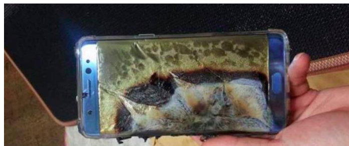
Figura 2. Samsung Galaxy Note 7, quemado por falla de hardware.
