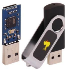
Figura 3. Apariencia del pendrive utilizado por Rubber Ducky
