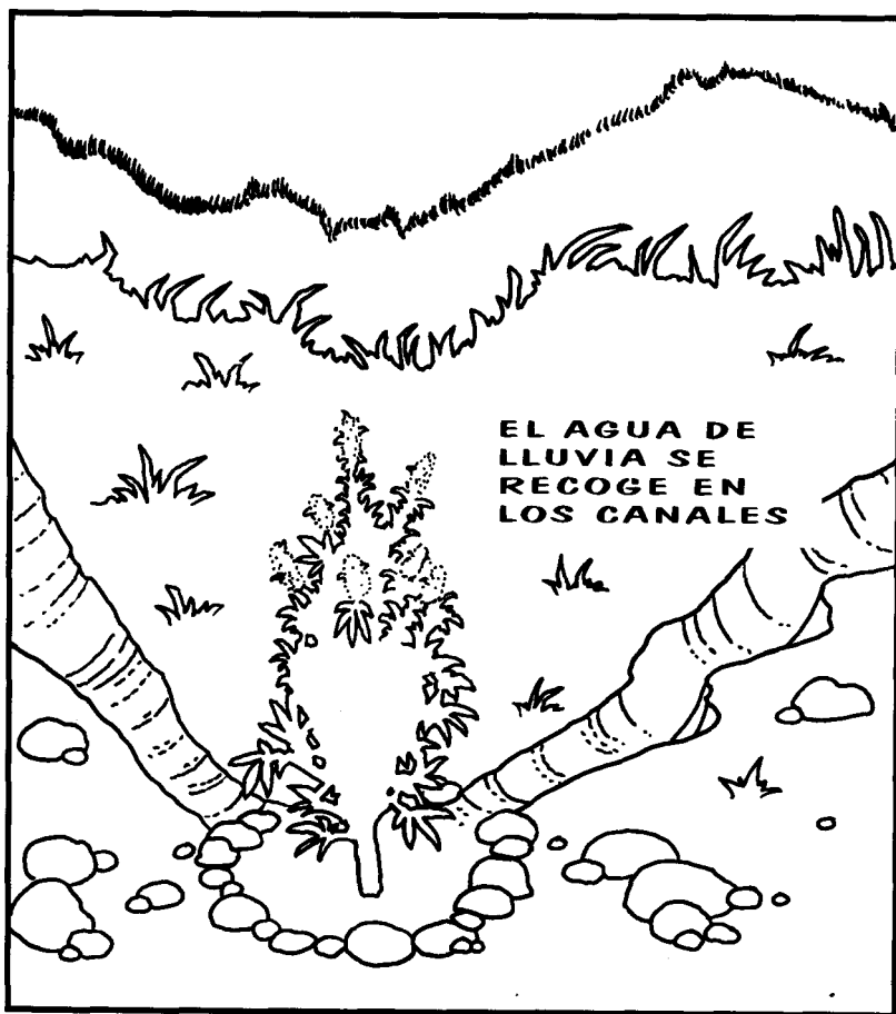
Las pequeñas zanjas conducen el agua de lluvia hacia las plantas.
