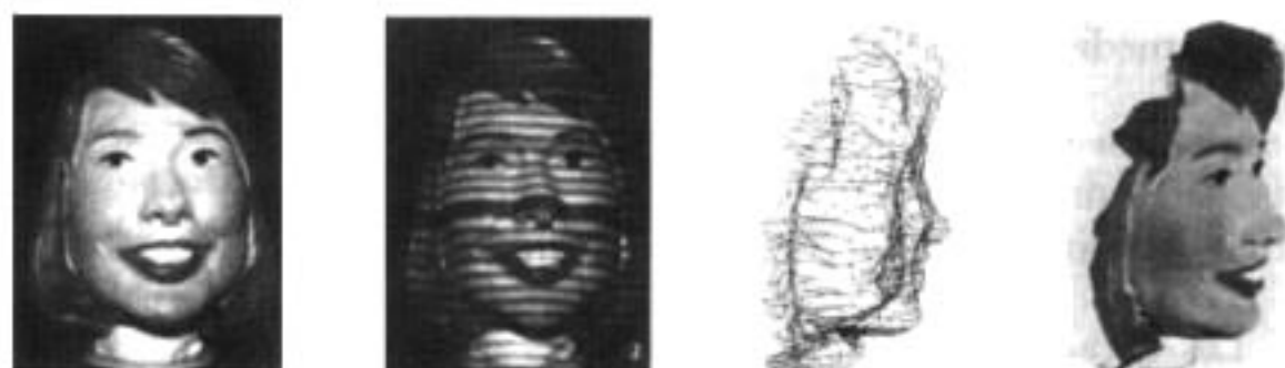
Figura 7.14. — Las 4 fases de la fotografía digital en 3D.
