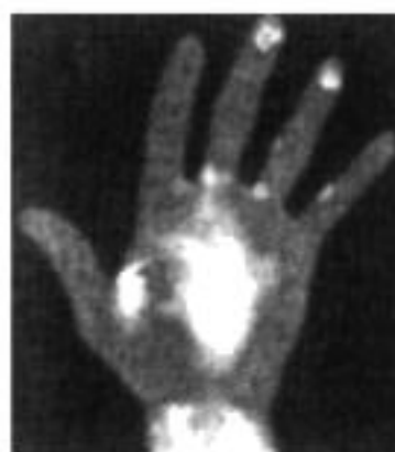
Figura 7.13. — Imagen térmica obtenida por una cámara de detector matricial.
