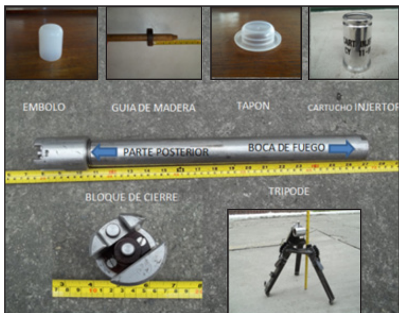
Figura 1. Cañón disruptor marca Pigstick
