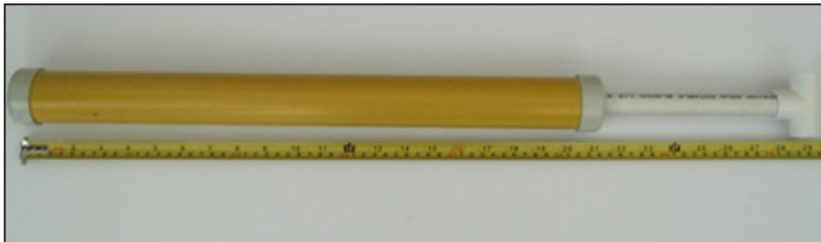
Figura 3. Dispositivo para la aspersión de la fécula elaborado en PVC.
