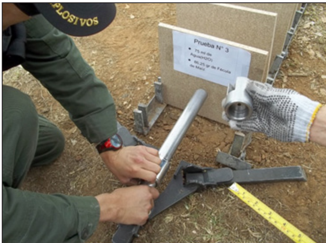
Figura 2. Instalación del cañón disruptor
