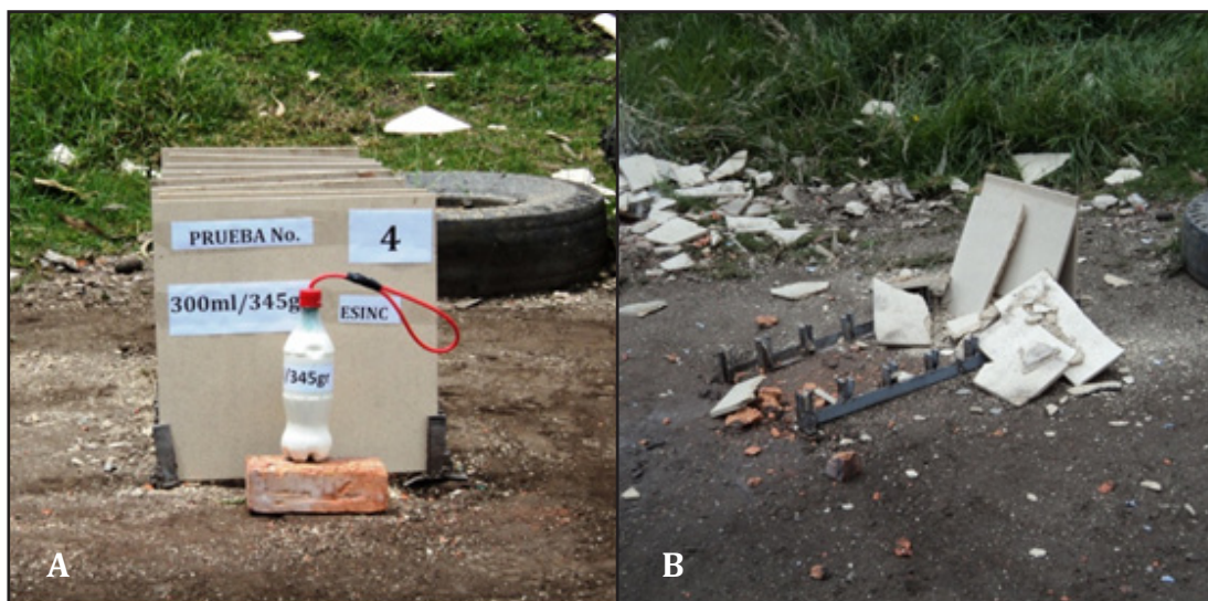
Figura 2. A. Fotografía donde se puede apreciar, el momento donde se instala la prueba No. 4, mezcla de 345grFM/300mlH 2 O. B. Fotografía donde se observa los efectos generados por la carga disruptiva.
