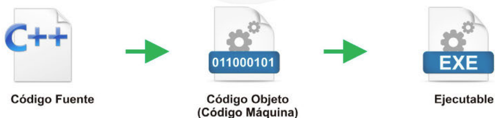
Figura 6.39. Esquema para crear un ejecutable
