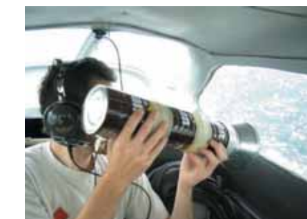
Figura 11. War Flying. Aquí vemos la utilización de una antena casera formada por la unión de tres latas
